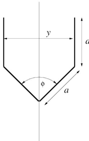
*Hinweis: Setzen Sie zunächst  $\phi/2 = \alpha$  und stellen Sie einen Ausdruck für die Querschnittsfläche auf, z.B.*
